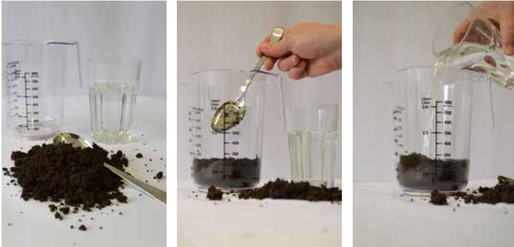
Humus, Löffel, Messbecher, Glas mit Wasser für Bodenluftmessung
