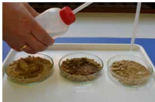
Die Bodenmaterialien werden mit Wasser angefeuchtet.
