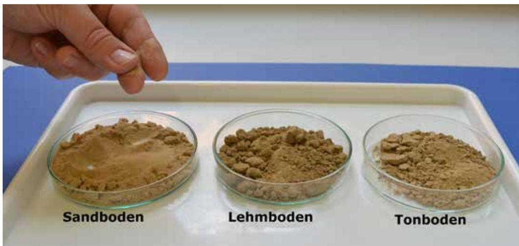
Mit der Fingerprobe kann man schnell und ohne weitere Hilfsmittel den Anteil von feinen und gröberen Teilchen abschätzen und so eine erste Einschätzung zur Bodenart vornehmen. Die Bodenprobe wird zwischen Daumen und Zeigefinger zerrieben, um die Körnigkeit festzustellen. Können grobe oder keine Körnchen gefühlt werden? Dann ist dies ein Hinweis auf den Bodenbestandteil Sand.
